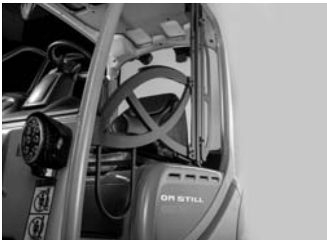
Sistema di ritenuta del conducente IWS
